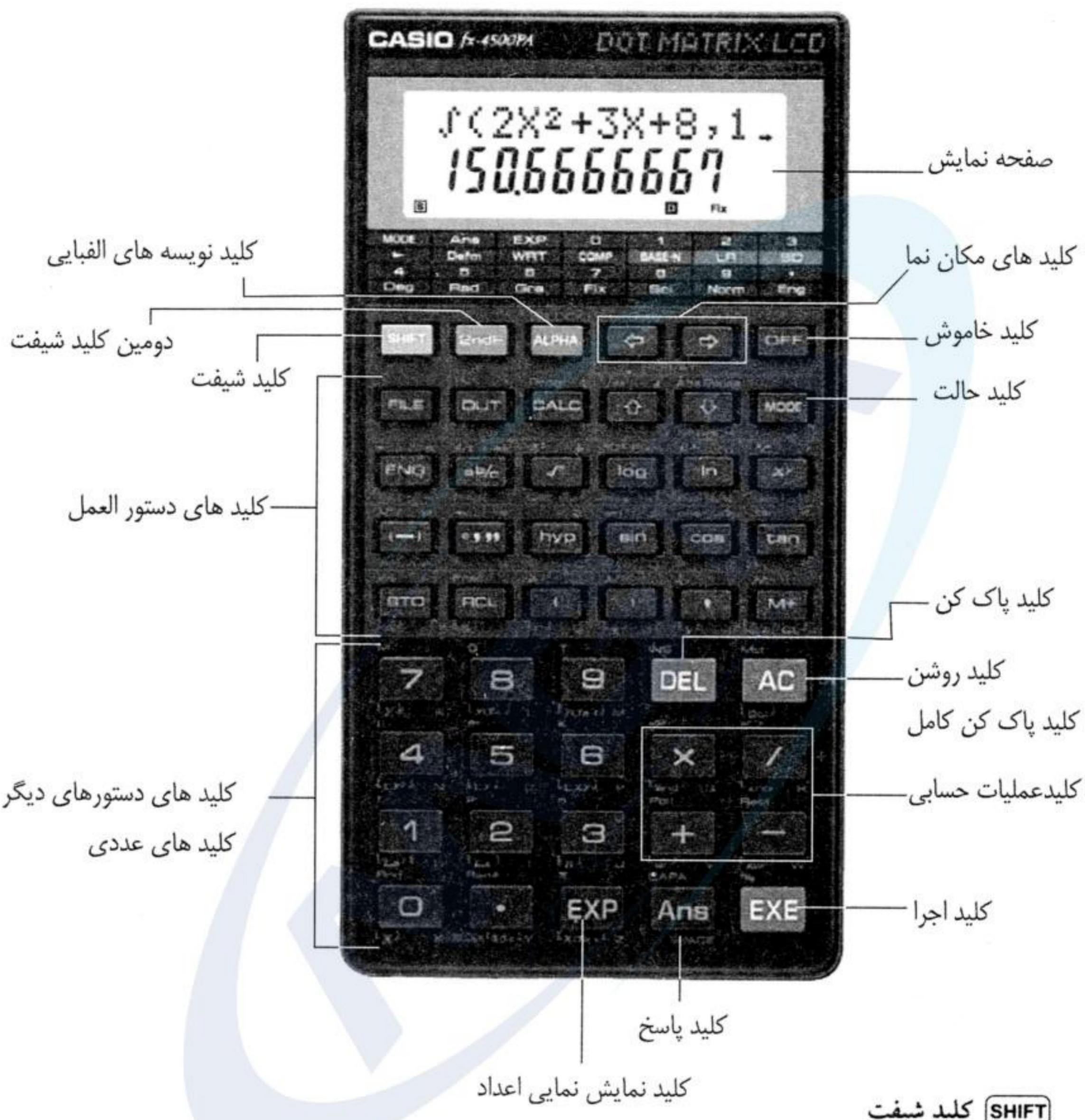
این کلید هنگام استفاده از دستورهای عمل و انجام عملهایی که با رنگ نارنجی بر روی کلیدها مشخص شده اند بکار می رود . با فشار دادن آن علامت "S" بر روی صفحه نمایش ظاهر می شود و با فشار دادن مجدد آن "S" ناپدید شده و دستگاه به حالتی که قبل از زدن کلید "SHIFT" داشت بر می گردد.
